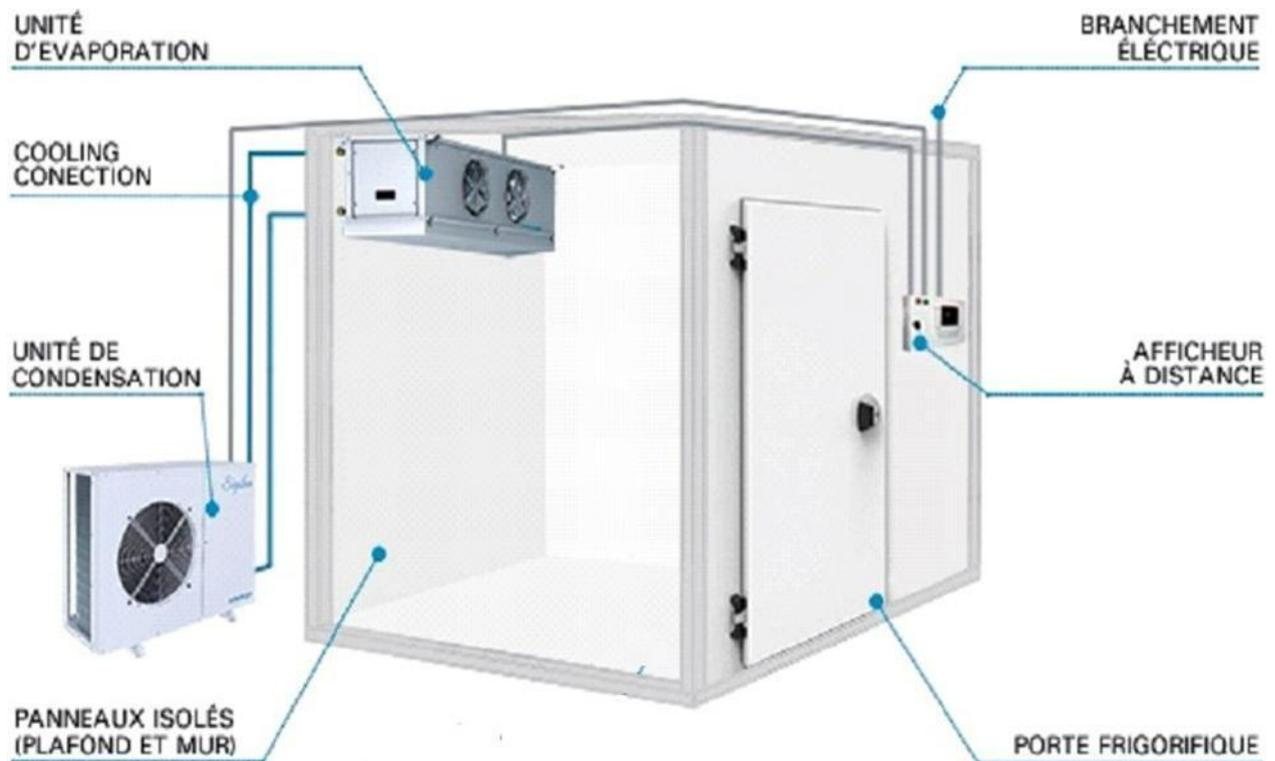
Figure1: Image de la chambre froide à installer
